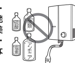
機器の損傷が著しく、また熱交換器のつまりなどにより不完全燃焼防止装置が作動し使用できなくなります。
