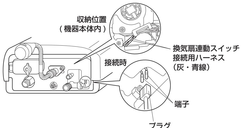
※ 接続する際は、換気扇連動スイッチ接続用ハーネスの端子(2カ所)の絶縁チューブを下図の点線(---)カットなどで切り込みを入れ、取りはずしてください。電線を切断したりキズを付けたりしないようご注意ください。また、接続後の配線を引き回す際は、むき出しことなる接続用端子部が機器本体などの金属部分に接触しないようにしてください。接触していると安全装置が作動し、機器を使用することができなくなります。
