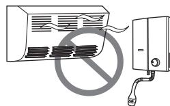
風によって爆発点火したり、機器本体給気口から炎や熱気があふれて、機器背面の壁・網戸・周囲の可燃物などを焦がすおそれがあります。また、炎が消えたり、不完全燃焼防止装置が作動することがあります。不完全燃焼防止装置が繰り返し作動することによって、機器を使用することができなくなります。
